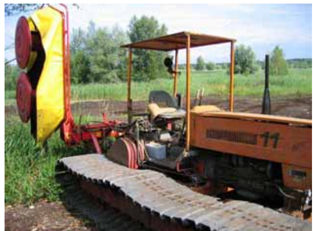
Abb. 16: Moorraupe mit dem über LIFE finanzierten Mähwerk (Ragger).
