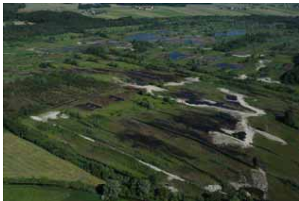
Abb. 48: Blick auf den Maßnahmenbereich 2005 im Nordwesten des Weidmooses. Die in der Bauphase 2005 errichteten Dämme sind durch die helle Farbe des Tons gut erkennbar. (Schrägluftaufnahmen © Leiningner Juni 2006)
